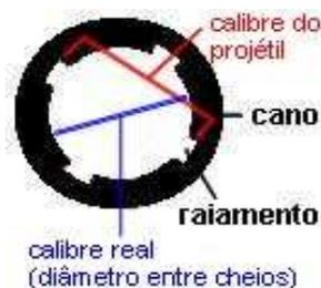
A alma é raiada quando o interior do cano tem sulcos helicoidais dispostos no eixo longitudinal, destinados a forçar o projétil a um movimento de rotação.
